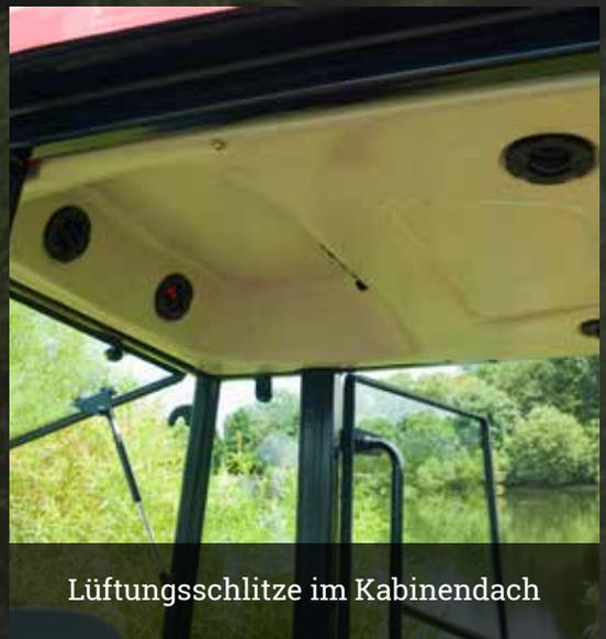
Lüftungsschlitze im Kabinendach
