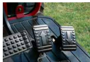
Hoher Fahrkomfort durch Hydrostatantrieb über 2 Pedalsteuerung oder 12/12 Gang Schaltgetriebe
