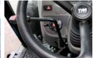
Hoher Fahrkomfort durch Hydrostatantrieb über 2 Pedalsteuerung oder 16/16 Gang Wendeschaltung
