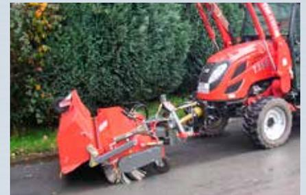
Kehmaschine mit Auffangbehälter
