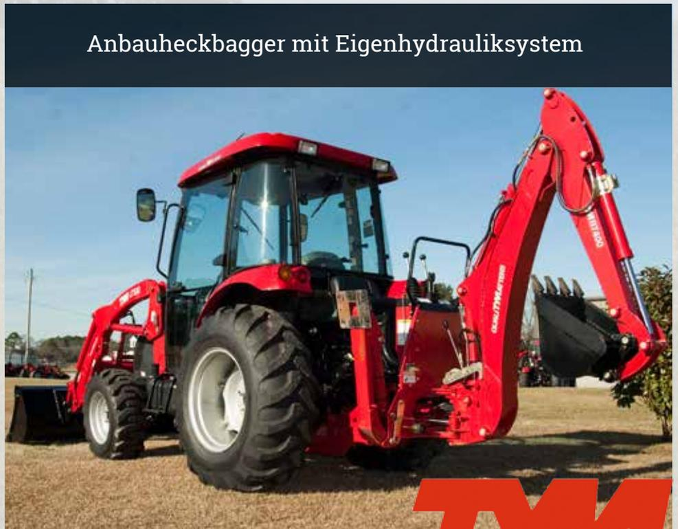
Anbauheckbagger mit Eigenhydrauliksystem
