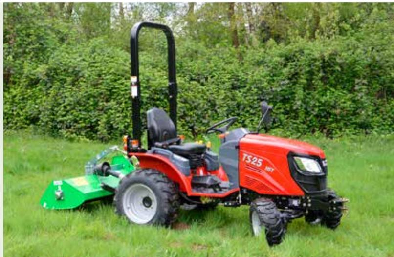
Der Peruzzo KOALA Schlegelmäher ist für Grasschnitt, Vertikutieren und gleichzeitiges Aufsammeln (auch Laub) in den Behälter konstruiert. Die Bodenentleerung erfolgt wahlweise manuell oder hydraulisch.
