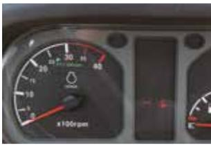
Zentrales Instrumentenpanel mit Kontrolleuchten, Drehzahlmesser, Tank- und Temperaturanzeige. Leicht zu erreichende Tempomatfunktion und elektrische Zapfwelleneinschaltung.
