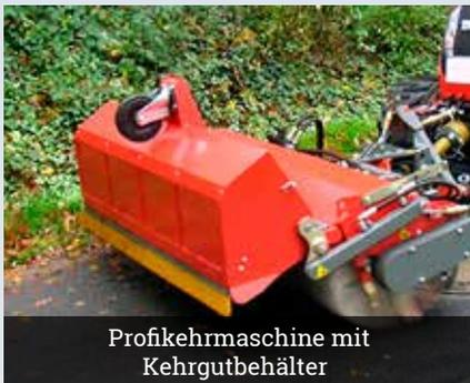
Profikehrmaschine mit Kehrgutbehälter
