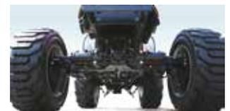
Extra starke und robuste Vorderachse mit hydraulischer Lenkung und großem Einschlagwinkel ermöglicht einen kleinen Wendekreis.
