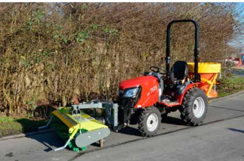
Die Arealtop Frontkehrmaschine mit 150 cm Arbeitsbreite und hydraulischer Schwenkeinrichtung ist für das Säubern von Höfen, Plätzen, Straßen und Wiesen geeignet. In Verbindung mit dem Arealtop Kommunalstreuer ist es eine perfekte Winterdienstkombination.
