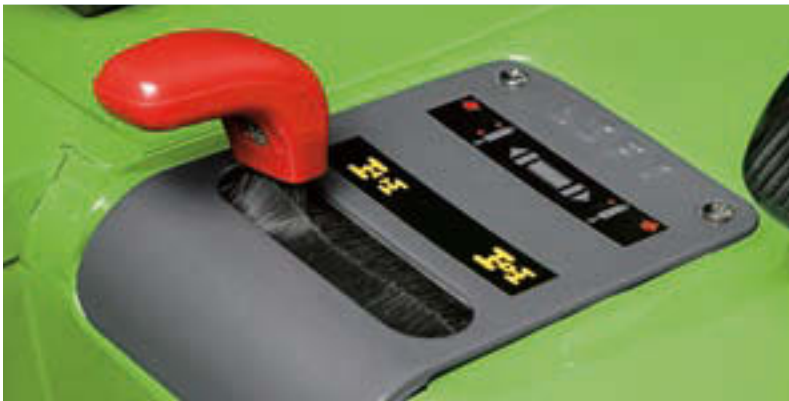
Der Vorderradantrieb kann bei Bedarf mechanisch zugeschaltet werden und erhöht so die Traktion erheblich.
