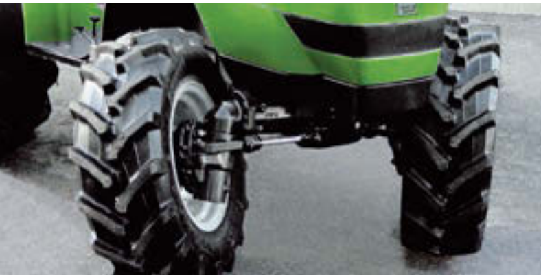
Mit 57° verfügt der Agrokid über einen sehr kleinen Wenderadius. Die Portalvorderachse ermöglicht eine hohe Bodenfreiheit von bis zu 390 mm.
