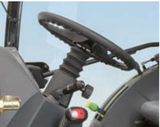
Das Lenkrad ist höhenverstellbar. Jeder Fahrer findet schnell seine ideale Sitzposition.
